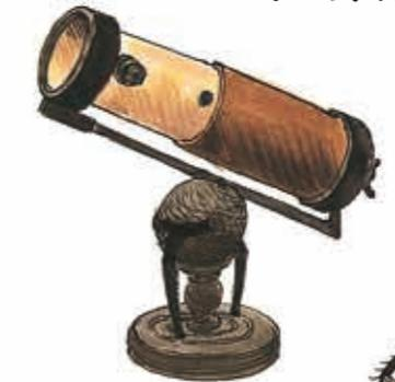
鏡で光を集めて反射させる「反射望遠鏡」。ぼやけないし、遠くのものも大きく見える。ニュートンは光の性質を研究して、ガリレオ式よりもよく見える望遠鏡を作ることができた。
