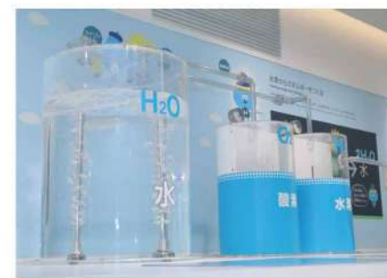
水素製造模型。水が水素と酸素に分解されるしくみを見ることができる。
