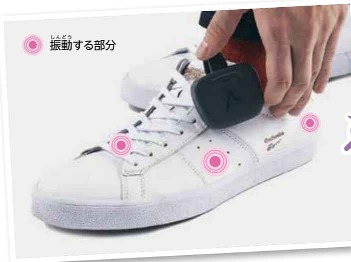
直進時は足の前方部分が振動、曲がる地点が近づくと左右の進行方向側の足が振動して知らせてくれる
