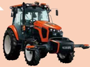
自動運転技術を備えたAgri Roboシリーズの農作業ロボットは人工衛星を使って現在位置を測定するGPSを利用して、作業をする田畑のマップと最も効率的な作業ルートを作ります。あとは、作業開始を指示するだけで、スタート地点に移動し、さまざまな農作業を安全に自動で行ってくれます。
