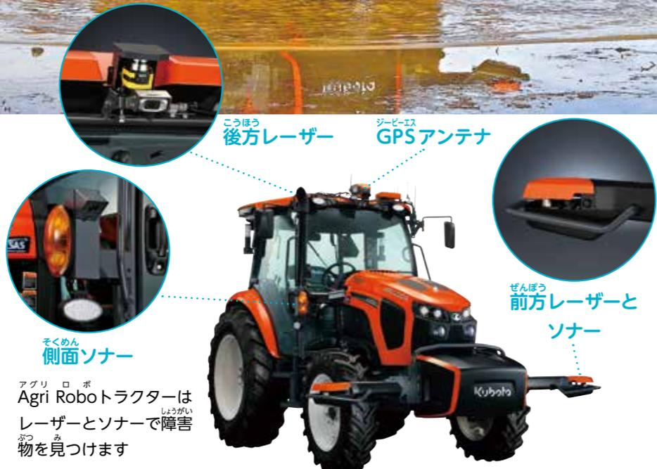
後方レーザー GPSアンテナ
