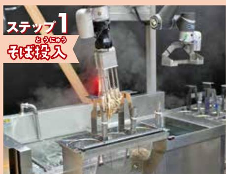
片方のアーム(左)が生そばをざるに、もう片方のアーム(右)がそのざるを麺ゆで機に投入
