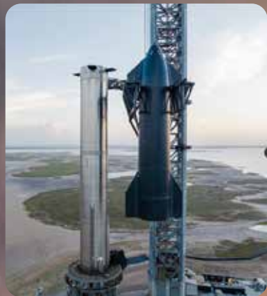
打ち上げの際は、スーパーヘビー（左）の上にスターシップ（右）を載せる
