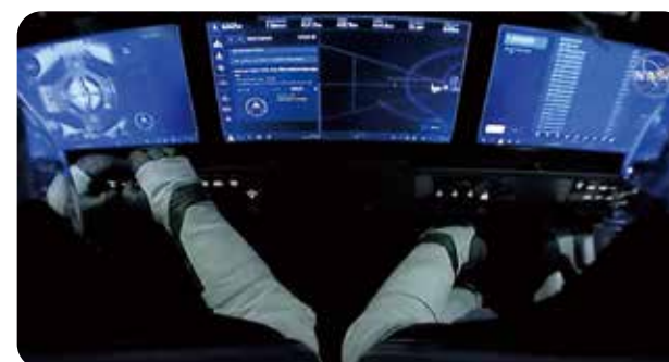
cockpitのタッチパネル式ディスプレイ。緊急時には宇宙飛行士がこのパネルを操作してロケットと宇宙船を切り離す ©NASA
