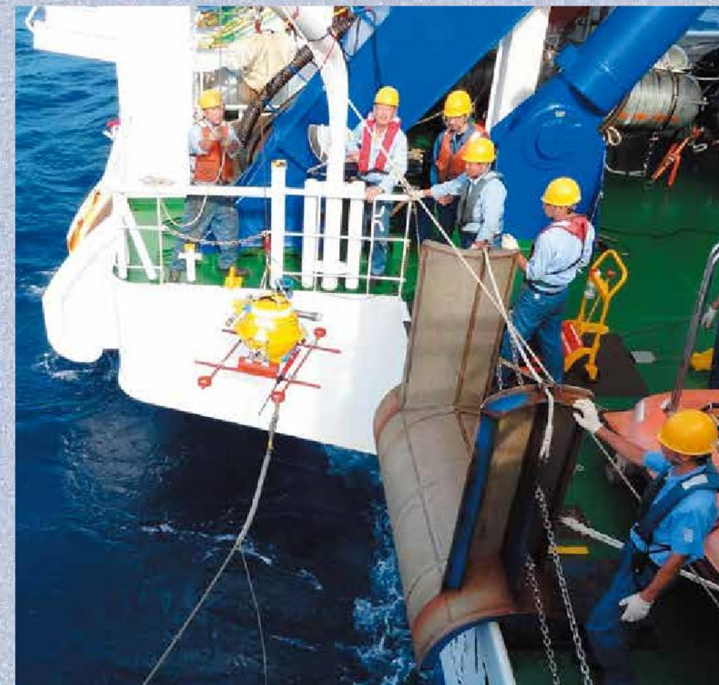
◀「かいれい」で設置される海底地震計。黄色の容器の中に地震計が入っています。赤い鉄の棒部分はおもりで、回収時にはこれを切り離して浮上してきます(15ページのコラム「海底地震計50年の歴史」を参照)。
