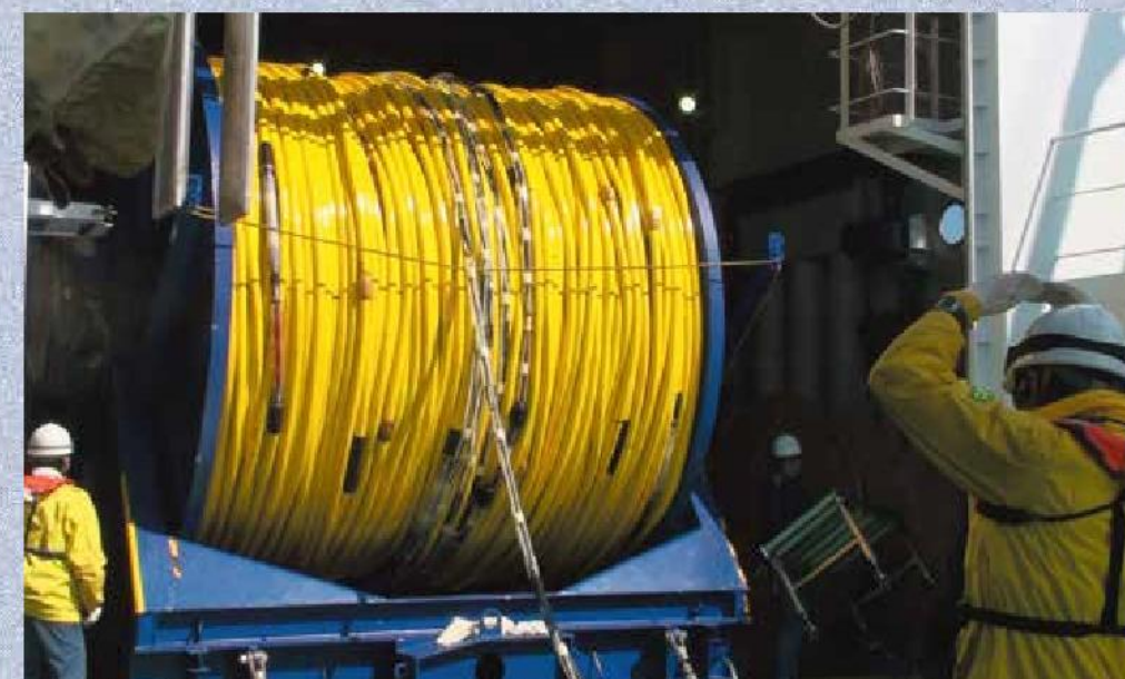
◀「かいれい」船上のストリーマーケーブル。リールに巻かれているケーブルを伸ばして船尾から引いて航行します。ケーブルの長さは約6キロメートルあります。
