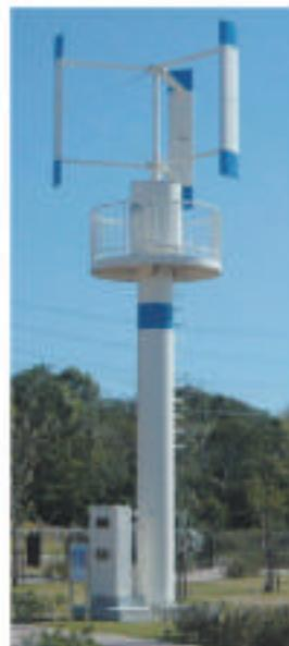
垂直軸型の羽を使った風力発電。
