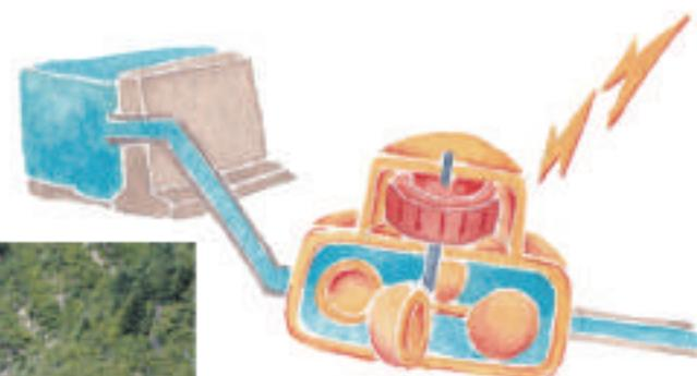
ダム式水力発電のしくみ。
