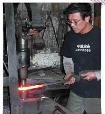
地金に刃金をつけて炉の中で熱したあと、ハンマーで打ちのばして包丁の形にする。
